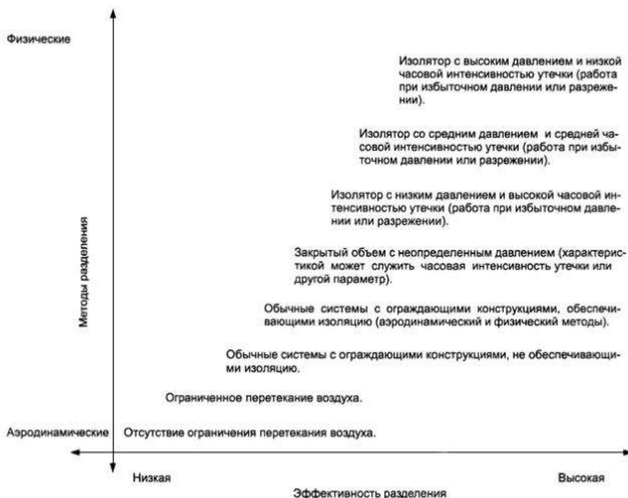
Рисунок А.1 - Иллюстрация эффективности разделения (изоляция) в зависимости от используемых методов (от аэродинамических до физических); сдвиг на схеме показывает приблизительную характеристику эффективности
